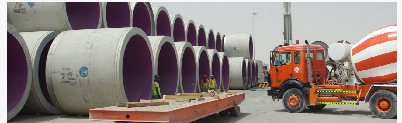
Футеровка внутренних поверхностей бетонных колец
